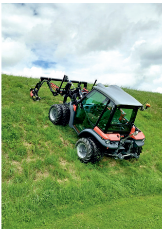
Hang-Geräteträger AEBI TT211 mit Doppelmessermähwerk
