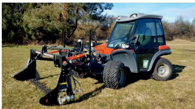
Sie suchen eine umweltschonende Lösung für die Pflege von steilen Hängen, nassen Wiesen oder Retentionsbecken? Dann sind Sie bei uns genau richtig. Mit unserem **Terratrak TT211** in Kombination mit einem Doppelmessermähbalken bieten wir professionelle Mäh- und Mulcharbeiten an – optimal für empfindliche Flächen und Böschungen.
